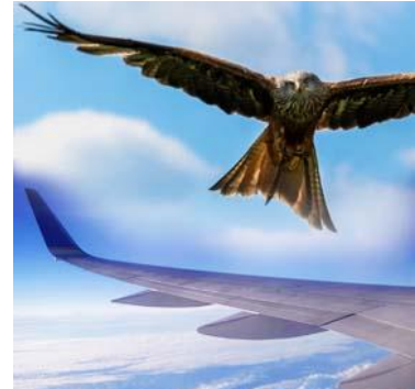
Abb. 1: Bionik: die von den Flügelspitzen inspirierten Winglets bewirken eine Reduktion des Ressourcenverbrauchs und der Emissionen.
